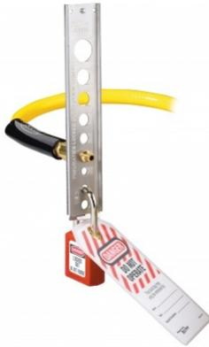
Le dispositif de condamnation MasterLock® S3900 est conçu dans le but d'empêcher que le raccord pneumatique soit connecté à une source d'air sous pression. Fonctionnant avec des morillons, ce dispositif de consignation accepte tous les cadenas de consignation, et convient à tout type de raccord pneumatique présent dans les installations industrielles.
