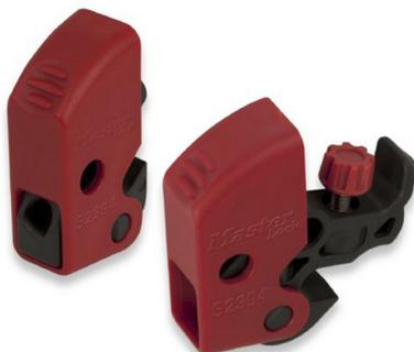
Le bloque disjoncteur S2394 MasterLock pouvant être utilisé en zones dangereuses, atmosphères explosives bloque le courant électrique. Ce bloque disjoncteur se fixe sur le maneton de 11mm ou moins, à l'aide d'une vis. La vis étant inaccessible une fois le bloque disjoncteur mis en place, celui ci peut être cadenasser.
