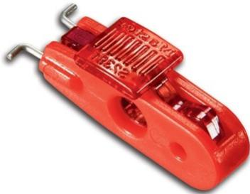
Le dispositif de condamnation électrique MasterLock - (S2391) est un mini bloque-disjoncteur convenant aux interrupteurs larges, qui se positionne sur le maneton (11mm ou +) d'un disjoncteur différentiel et coupe le courant électrique à la source. Adapté aux zones dangereuses et atmosphères explosives, ce dispositif de condamnation fonctionne avec tous les cadenas et morillons de consignation.
