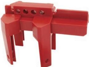
Le dispositif de consignation de vannes 1/4 de tour universel S3080 est compatible avec les vannes de 12,7 à 63,5mm. Cette consignation de vannes universelle permet de verrouiller les vannes en position ouverte ou fermée et permet également d'éviter une ouverture accidentelle. Grâce à la condamnation de vannes à 4 pieds, il est possible de passer un câble de consignation à travers les pieds du dispositif pour renforcer sa fixation sur la vanne et le tuyau.
