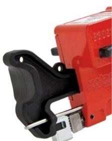
Le dispositif de condamnation de vannes 1/4 de tour MasterLock® S3068MLP s'adapte aux espaces restreints, tuyaux calorifugés, et convient aux conditions extrêmes, environnements corrosifs. Cette condamnation de vannes se fixe sur la poignée d'arrêt pour prévenir tout mouvement de cette dernière, et est dotée de mâchoires ajustables afin de maintenir la vanne en position. Ce système de consignation de vannes fonctionne avec tous les cadenas et morillons de consignation de la gamme MasterLock®.
