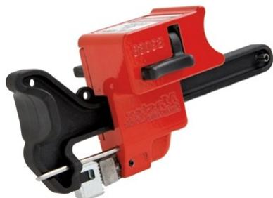
Le dispositif de condamnation de vannes 1/4 de tour MasterLock® S3068MLP s'adapte aux espaces restreints, tuyaux calorifugés, et convient aux conditions extrêmes, environnements corrosifs. Cette condamnation de vannes se fixe sur la poignée d'arrêt pour prévenir tout mouvement de cette dernière, et est dotée de mâchoires ajustables afin de maintenir la vanne en position. Ce système de consignation de vannes fonctionne avec tous les cadenas et morillons de consignation de la gamme MasterLock®.
