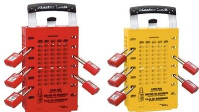
La boîte de consignation de groupe Latch Tight MasterLock® 503RED est dotée de 12 encoches pour la fixation des clés et est verrouillable par 14 cadenas (type 410-406). La boîte de consignation garde les clés jusqu'à ce que le dernier cadenas soit retiré afin que la condamnation des équipements soit efficace et sans danger. Le mécanisme exclusif Latch Tight Master Lock® garantit que personne n'ait accès aux clés. Ce dispositif de stockage peut avoir une application murale ou portable.
