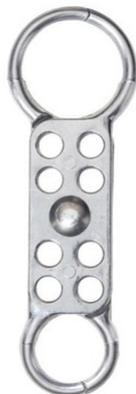
Le morillon de consignation en aluminium MasterLock® 429 condamne un équipement, par un ou plusieurs travailleurs. Acceptant jusqu'à 8 cadenas dont l'anse ne dépasse pas 6,35mm de diamètre, ce morillon de condamnation est équipé de deux mâchoires.
