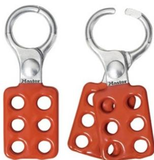
Les morillons consignation en aluminium et revêtement vinyle MasterLock® - (416 et 417) permettent une condamnation par plusieurs travailleurs d'un même équipement. L'équipement étant hors d'usage lors d'opérations de maintenance, tous les cadenas (au nombre de 6 au maximum, dont l'anse ne dépasse pas 6.35mm de diamètre) doivent être retirés pour réactiver le système.
