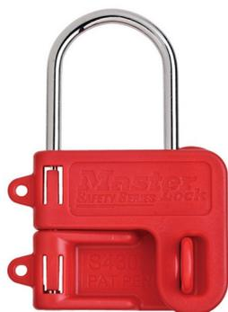
Le dispositif de condamnation électrique pour disjoncteur moteur MasterLock® S430 est un crochet de consignation de 4mm de diamètre idéal pour les disjoncteurs-moteurs. Ce crochet de consignation peut accepter jusqu'à 2 cadenas dont l'anse ne dépasse pas 6mm de diamètre.
