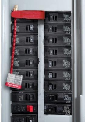
Le cadenas de condamnation électrique pour interrupteur-disjoncteur MasterLock® 7C5RED à clés différentes est doté d'une anse-câble d'un diamètre de 3/16mm permettant de consigner tous les types de disjoncteur. La flexibilité du câble en acier de 127mm de long permet de positionner le corps du cadenas de consignation de façon à ce que les portes à panneaux puissent être fermées.
